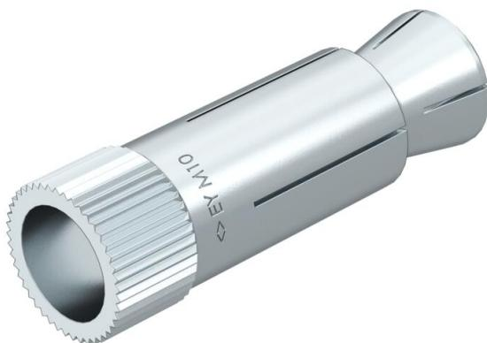
Bucha de ancoragem Easy para a montagem em placas de tetos falsos em betão pré-esforçado. Ao apertar o parafuso ou a porca, o cone é solto da bucha e é deslizado para dentro do parafuso ou da porca. Deste modo, a bucha expande-se no espaço vazio preenchendo os espaços. A bucha de ancoragem pode ser utilizada se a área de expansão não se situar numa câmara oca.
