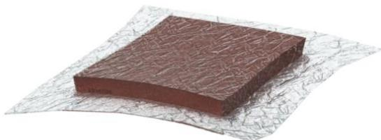
Versão embalada a vácuo do bloco de espuma FBA-B200-14 para o fecho simples do espaço restante no compartimento a selar com bloco PYROPLUG®. Após o fim da montagem, a película é cortada e o bloco expande-se para o seu tamanho original. A película pode permanecer na selagem. Aplicação em áreas interiores.
