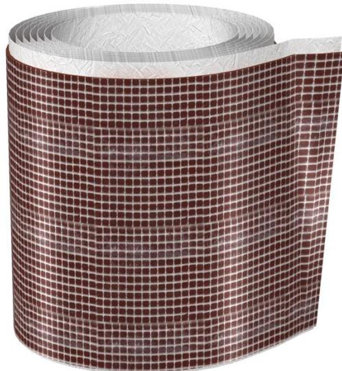
Fita intumescente autoadesiva, com 5 mm de espessura, para aplicação com diâmetros de cabos grandes e em caminhos de cabos; pode ser utilizada nos sistemas PYROPLUG® e PYROSIT® NG. Aplicação em áreas interiores.
