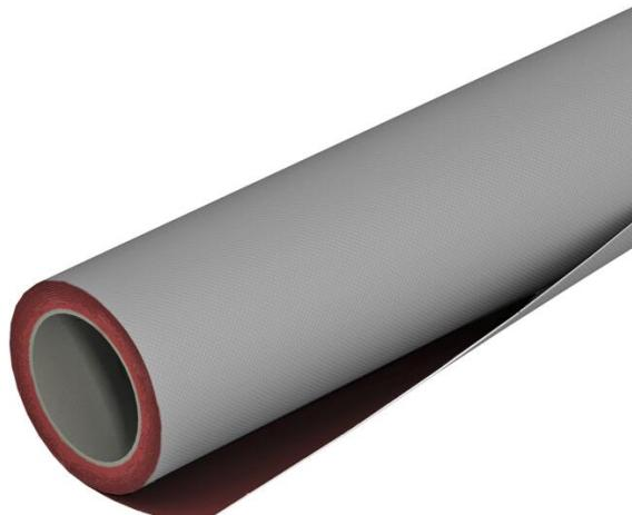
Tecido de proteção contra incêndio, resistente a intempéries, de malha flexível com revestimento para prevenção da propagação dos incêndios em cabos ou sistemas de caminhos de cabos. Lado exterior cinzento, interior vermelho. Um rolo contém 22 m<sup>2</sup>.
