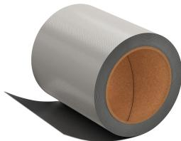
Envoltura de proteção contra fogo revestida de um dos lados com espuma anti-fogo para envolver instalações de selagens com argamassa PYROMIX® e placas PYROPLATE®. O tecido de suporte inclui isolamento intumescente de um lado. A espessura nominal é de 1,5 mm.
