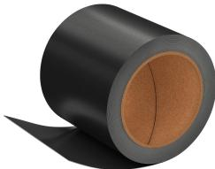
Envoltura de proteção contra fogo revestida de dupla face com espuma antifogo para envolver instalações de selagens com argamassa PYROMIX® e placas PYROPLATE®. O tecido de suporte inclui isolamento intumescente em ambos os lados. A espessura nominal é de 1,5 mm.
