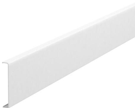
Tampa em alumínio, para o fecho da calha técnica Rapid GA e colunas de distribuição ISS com uma abertura de sistema de 76,5. A fixação correta da tampa e o contacto elétrico da calha/base e da coluna é garantido graças aos grampos de ligação tipo RKV3V. Cada comprimento fornecido (2000 mm) inclui 6 grampos de ligação pré-montados.
