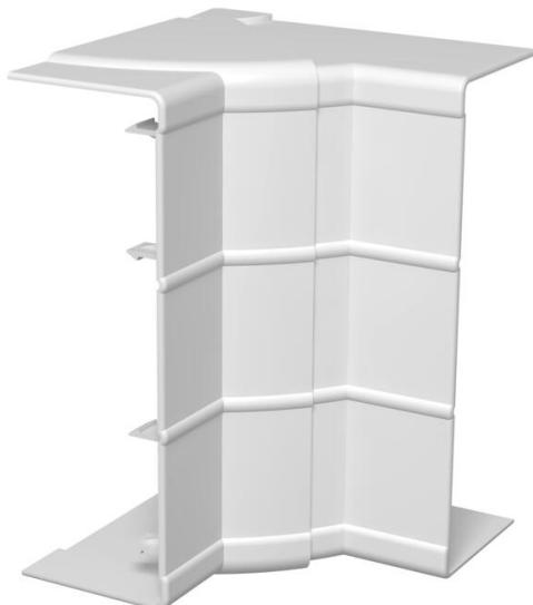
Ângulo interno como acessório variável para alteração da direção de calhas técnicas Rapid 45 de 3 tampas. Os acessórios podem variar de 80 - 103°.
