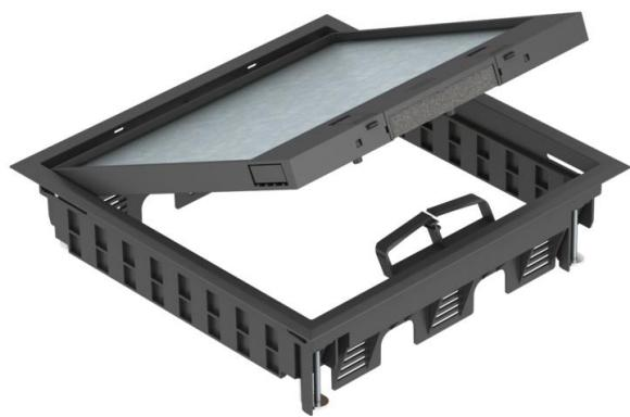
Tampa de encastramento com corrediça de encaixe para até 12 aparelhos Modular 45 em 3 suportes universais UT4, utilização em sistemas de calhas de pavimento e chão falso em interiores.
