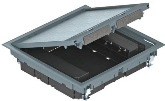
Tampa de encastramento GES9 com uma altura de instalação fixa de 55 mm para utilização em sistemas de calhas de instalação em espaços secos interiores com piso tratado a seco. Com dois suportes de aparelhos para montagem vertical de aparelhos Modul 45 e quatro fixadores para alívio de tensão. Para a montagem de aparelhagem Modul 45 são necessárias dois suportes de aparelhos.
