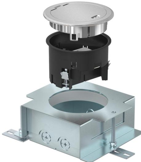
Tampa redonda GES R2 com tampa basculante, estrutura de proteção do pavimento e caixa de betonilha UD GES R2 para montagem em chão de betonilha em áreas interiores. Tampa de encastramento com uma tomada Schuko dupla com alvéolos inclinados a 33°. Lateralmente, perto da tomada existe espaço para instalar, opcionalmente, até 2 conectores de dados. No estado fechado, a tampa pode ser limpa a húmido. A profundidade mínima de montagem é de 85 mm. Superfície cromada.
