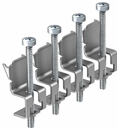
Quatro fixações universais para tampas de encastramento redondas e adaptadores para caixas de pavimento de tamanho R4, R7 e R9 em sistemas de calhas, chão falso, bem como para tampas de encastramento quadradas e adaptadores para caixas de pavimento de tamanhos 4, 6 e 9 em sistemas de calhas. Para fixação da tampa de encastramento GRAF9 são necessárias oito fixações universais. Peça de substituição.
