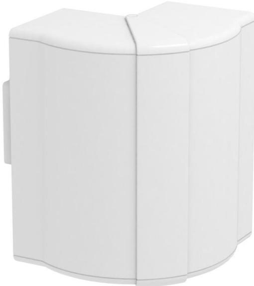
Tampa de ângulo externo em PC/ABS, livre de halogéneos, para alteração da direção das calhas Rapid 80, do sistema GK, GKH, GS e GA. Os acessórios podem variar entre 80° a 100° e podem ser inseridos em calhas simétricas ou assimétricas.
