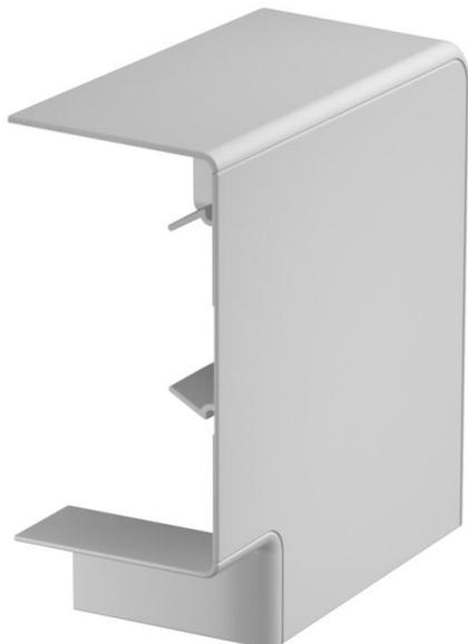
Ângulo plano em PC/ABS livre de halogéneos para criação fácil de alteração da direção de subida ou descida a 90° com calha técnica da série Rapid 80 GK, GKH, GS e GA. O ângulo plano é adaptável a canais de tipo simétrico e assimétrico.
