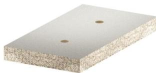
Placa antifogo perfurada (classe de materiais A1) como medida de revestimento eficaz para a fixação em componentes de suporte de madeira para a manutenção de funções conforme a DIN 4102 parte 12. Composta por betão leve de fibra de vidro resistente a água e a geada.
