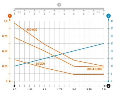
Diagrama de cargas do caminho de cabos em varão de tipo GRM 55 VA
