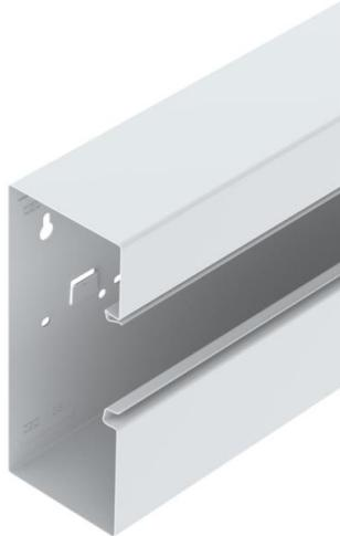
Calha técnica GS para a montagem direta na parede ou nas consolas de fixação. A calha técnica GS dispõe de patilhas de encaixe com contactos para a integração de um separador de chapa de aço. A compensação entre as bases da calha ocorre através da união. Entre a tampa e a base, a medida de proteção e a ligação equipotencial são garantidas através do encaixe e fixação da tampa na calha. A abertura do sistema é de 76,5 mm. A tampa tem de ser encomendada em separado.
