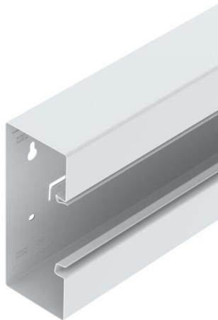
Calha técnica GS para a montagem direta na parede ou nas consolas de fixação. A calha técnica GS dispõe de patilhas de encaixe com contactos para a integração de um separador de chapa de aço. A compensação de potencial entre as bases da calha ocorre através da união. Entre a tampa e a base, a medida de proteção e a ligação equipotencial são garantidas através do encaixe e fixação da tampa na calha. A abertura do sistema é de 76,5 mm. A tampa tem de ser encomendada em separado.
