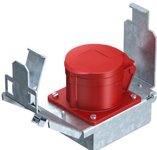
Suporte de aparelhos de tamanho 2, com uma tomada CEE de 16 A, para a montagem em tampas e caixas de tamanho nominal de 2, 4, 6 e R7. Suporte de aparelhos com base de proteção e fixadores de alívio de tensão. Profundidade mínima necessária de montagem: 190 mm com a utilização de uma ficha reta e 160 mm na utilização de uma ficha de tomada angular.
