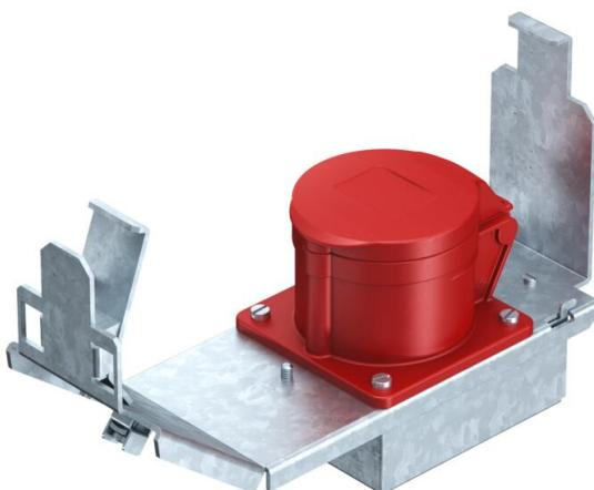
Suporte de aparelhos de tamanho nominal 3, com uma tomada CEE de 16 A para montagem em tampas e caixas de tamanho nominal R7, 9 e R9. Suporte de aparelhos com base de proteção e fixadores de alívio de tensão. Profundidade mínima necessária de montagem: 190 mm com a utilização de uma ficha reta e 160 mm na utilização de uma ficha de tomada angular.
