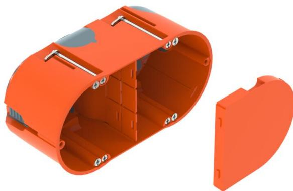
Caixa de eletrónica com entradas de membrana, tampa e separador, para utilização em paredes ocas com uma profundidade de instalação de pelo menos 61 mm e uma espessura de placa de 5 - 40 mm.
