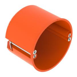
Caixa de aparelhagem CEE/PERILEX para utilização em paredes ocas com uma profundidade de instalação de pelo menos 61 mm e uma espessura de placa de 5 - 40 mm.
