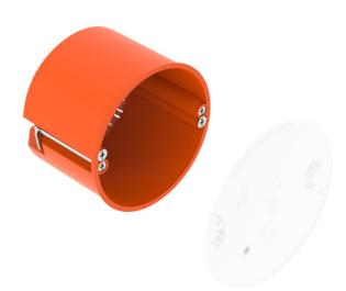
Caixa de aparelhagem CEE/PERILEX com tampa, para utilização em paredes ocas com uma profundidade de instalação de pelo menos 61 mm e uma espessura de placa de 5 - 40 mm.
