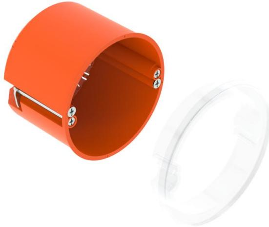
Caixa de aparelhagem CEE/PERILEX com anel de selagem, para utilização em paredes ocas com uma profundidade de instalação de pelo menos 61 mm e uma espessura de placa de 5 - 40 mm.
