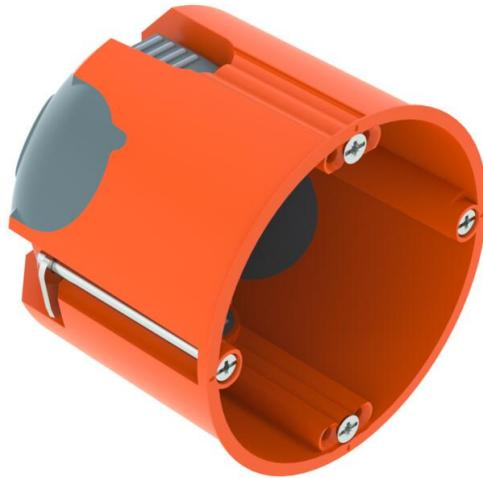
Caixa de aparelhagem com entradas de membrana herméticas, para utilização em paredes ocas com uma profundidade de instalação de pelo menos 61 mm e uma espessura de placa de 5 - 40 mm.
