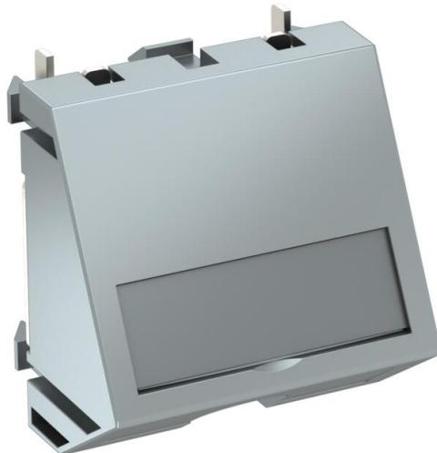
Saída de cabo de 2 componentes, com campo de inscrição, composta por um suporte de cabos com alívio de tensão e por uma cobertura. O alívio de tensão é indicado para diâmetros de cabo de 3-11 mm. A saída tem uma tampa deslizante de bloqueio, adequada tanto para a instalação vertical como horizontal.
