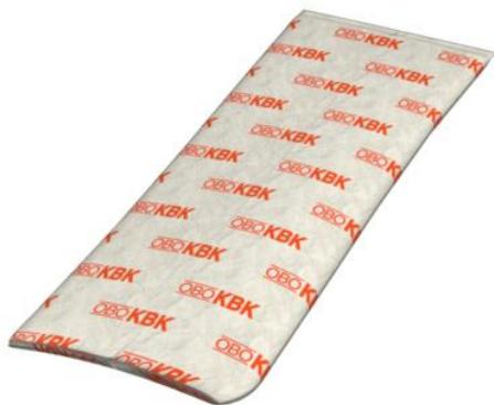
Almofada de proteção antifogo com fibra de vidro intrincada e isolante, de fixação mecânica, com enchimento especial. Sem fibras minerais, resistente ao clima e à prova de água. Aplicação em áreas interiores.
