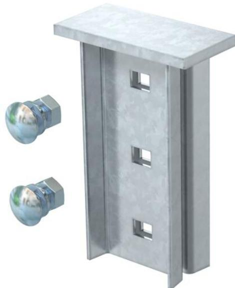
Cabeça de pendural para soldar em construções de edifícios. Os pendurais podem ser fabricados no local em todos os comprimentos, a partir do perfil IS 8. O comprimento do varão deve perfazer, no máximo, 2000 mm. A cabeça de pendural pode ser montada em perfil IS 8. A cabeça do pendural é fixa no perfil com dois parafusos FRS M10X25, encomendados separadamente.
