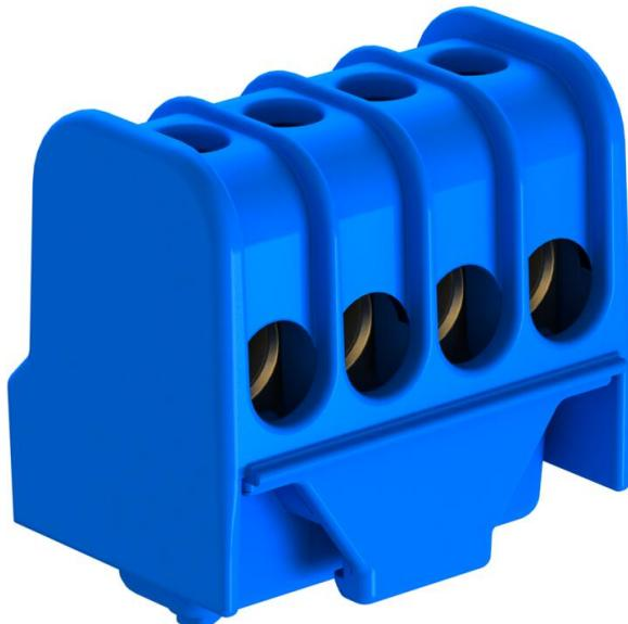
Borne de ligação com condutor neutro em latão, parafusos em aço, galvanizado a zinco e passivado de forma transparente, secção transversal nominal 6 ÷ 16 mm<sup>2</sup>, tensão nominal 400 V, 1 polo, com bloco de conetores condutores conectáveis máx. por ponto de aperto máx. 4 x 16 mm<sup>2</sup>, 4 x 10 mm<sup>2</sup>, 8 x 6 mm<sup>2</sup> ou 12 x 4 mm<sup>2</sup>.
