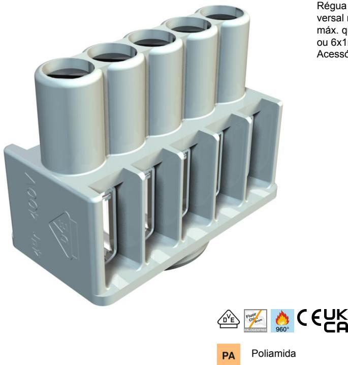
Régua de bornes e parafusos em aço galvanizados e passivados, secção transversal nominal 1 ÷ 4 mm<sup>2</sup>, tensão nominal 400 V, 5 polos, secção transversal máx. que pode ser ligada por cada ponto de aperto: máx. 4x2,5mm<sup>2</sup>, 5x1,5mm<sup>2</sup> ou 6x1mm<sup>2</sup>.
