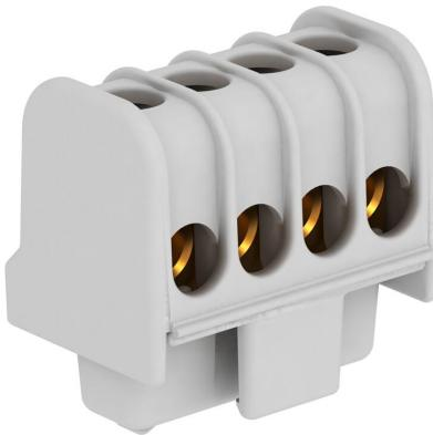
Bornes em latão, parafusos em aço, galvanizados e passivados de forma transparente, secção transversal nominal de 6 ÷ 16 mm<sup>2</sup>, tensão nominal de 400 V, de 1 polo, com conjunto de bornes max. 4x16mm<sup>2</sup>, 4x10mm<sup>2</sup>, 8x6mm<sup>2</sup> ou 12x4mm<sup>2</sup>.
