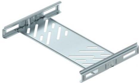
união de caminho de cabos em chapa com fixação rápida para a ligação, sem parafusos, de caminhos de cabos perfurados com uma altura lateral de 35 mm. O seu design otimizado permite ser utilizada na execução de raios e compensações de comprimentos em grandes variações.
