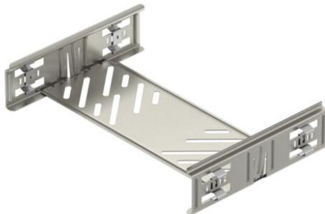
União de caminho de cabos em chapa com fixação rápida para a ligação, sem parafusos, de caminhos de cabos perfurados com uma altura lateral de 60 mm. O seu design otimizado permite ser utilizada na execução de raios e compensações de comprimentos em grandes variações.
