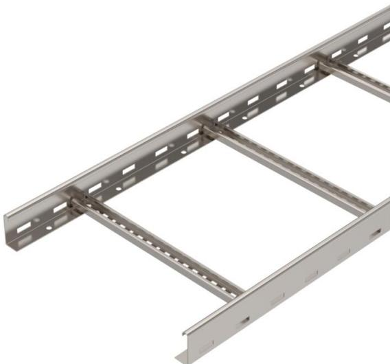
Caminho de cabos tipo escada com altura lateral de 60 mm com perfil separador C30 soldado e rebitado para cima. Travessa lateral revirada para reforço e como proteção de arestas. A fixação na consola é efetuada com peças de aperto do tipo LKS 40. A dimensão da ranhura do degrau é de 16,5 mm e a abraçadeira BBS adequada é a do tipo 2056. Atenuação da blindagem magnética sem tampa 10 dB, com tampa 15 dB.
