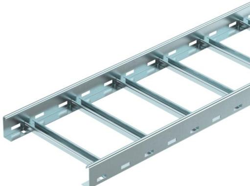
Escada para a colocação vertical de cabos e condutores. Aplicável como estrutura de suporte normalizada para a manutenção de funções conforme a DIN 4102 parte 12 Classes de manutenção de funções E30 até E90. Com degrau em perfil C rebitado com abertura para cima.
