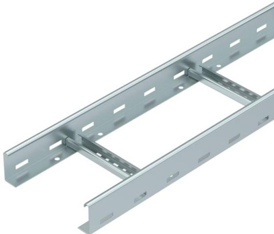
Caminho de cabos tipo escada com aba perfurada de 60 mm com degraus em perfil C, rebitados e abertos para cima (versão VS). O caminho de cabos tipo escada é fornecido fechado.
