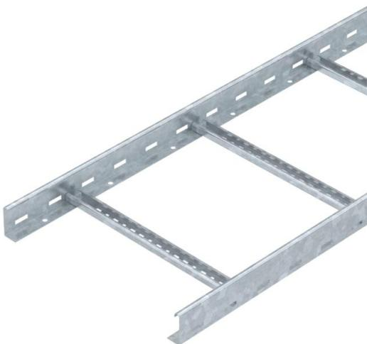
Caminho de cabos tipo escada com aba perfurada de 60 mm com degraus em perfil C, rebitados e abertos para cima (versão VS).
