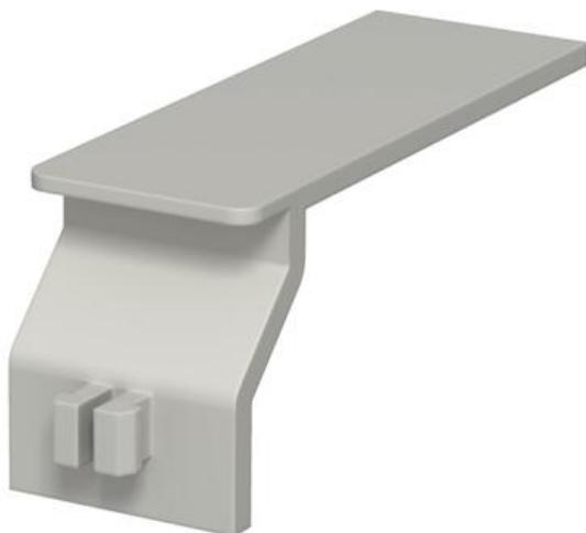
Grampo de segurança para as calhas de cablagem tipo LK4 e LK4 N. O grampo de segurança evita a queda dos cabos já instalados. Através dos pontos de ruptura previstos pode-se reduzir o comprimento para as diferentes larguras de calha a 38, 28 e 23 mm.
