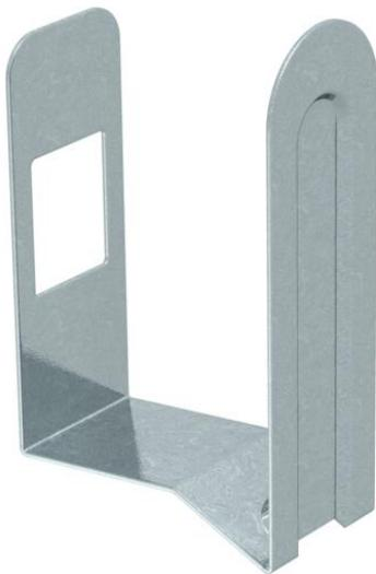
O grampo mantém os cabos e tubos inseridos nas calhas e facilita, desse modo, a instalação na parede e no teto. Os grampos para calhas são inseridos na perfuração sequencial e encaixados da base da calha. Adequado para larguras de calha de 100 mm.
