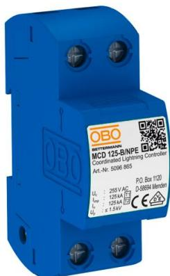
MCD 125-B/NPE: explosor de equipotencial coordenado N-PE do tipo 1+2 conforme a EN 61643-11. Para interface 0 em 2 (LPZ) de acordo com o conceito de zonas de proteção contra descargas atmosféricas conforme a IEC 62305 ou VDE 0185-305.
