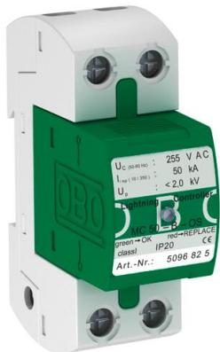
MC 50-B-OS: descarregador atmosférico com indicador ótico de funcionamento tipo 1 conforme DIN EN 61643-11 para interseção 0 em 1 (LPZ) de acordo com o conceito de zonas de proteção contra descargas atmosféricas conforme IEC 61312-1 ou VDE 0185-305 (IEC 62305).
