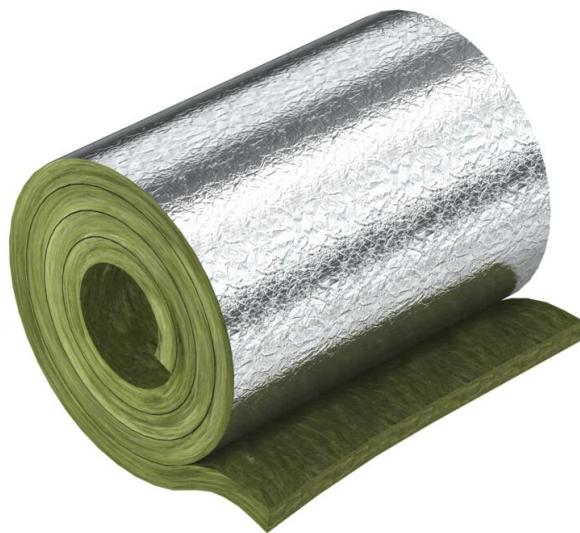
Lã mineral com forro de alumínio para selagens de percursos em tubos de cobre e aço. Fixação da selagem de passagens com fio de enrolar e proteger as juntas de choque com fita adesiva em alumínio.
