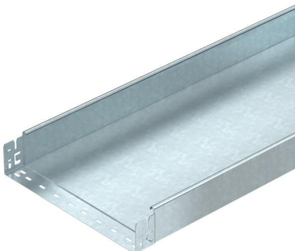
Caminho de cabos em chapa não perfurado com união de encaixe rápido integrada. O comprimento útil do caminho de cabos em chapa é de 3.000 mm. A ligação equipotencial continua é garantida sem componentes adicionais.
