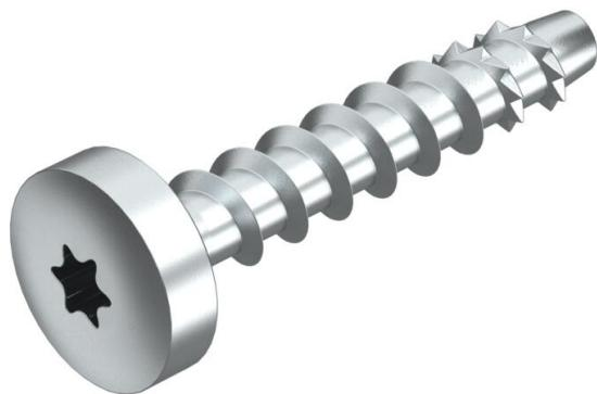
Parafuso de ancoragem para montagem direta sem bucha em betão fissurado ou não fissurado, bem como alvenaria. Com cabeça redonda para fixações universais. Acionamento Torx T30.
