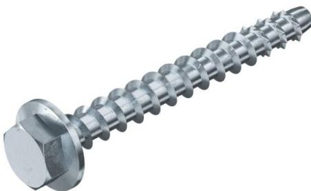
Parafuso de ancoragem para montagem direta sem bucha em betão fissurado ou não fissurado, bem como alvenaria. Com acionamento hexagonal e anilha prensada para acomodar grandes cargas. Adequado para a fixação de suportes suspensos e consolas de parede em compartimentos húmidos e em áreas exteriores.
