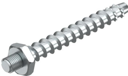
Parafuso de ancoragem para montagem direta sem bucha em betão fissurado ou não fissurado, bem como alvenaria. Rosca M6 para a fixação de clip com pé roscado.
