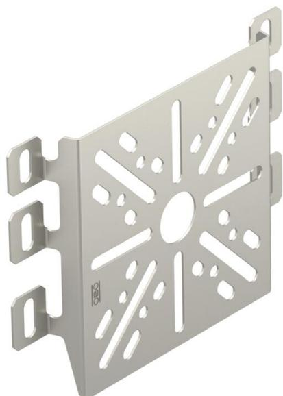
Suporte de caixas para fixação na aba do caminho de cabos em chapa. A fixação na aba lateral do caminho de cabos em varão é efetuada sem parafusos, dobrando apenas a patilha de encaixe. A fixação na aba lateral do caminho de cabos em chapa ou tipo escada é efetuada com dois parafusos de cabeça boleada. A caixa de derivação tipo B9/T é fixa através de um parafuso apertado no centro da caixa ao orifício central do suporte.
