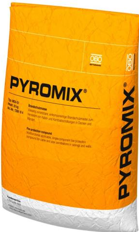
Argamassa para selagens de cabos e combinação de selagens em paredes e tetos maciços. Adequada para bombas, prensas e para instalação manual. Adicionar aproximadamente 6 litros de água a 20 kg de argamassa seca, produz cerca de 20 litros de massa própria para processamento. Aplicação em áreas interiores.
