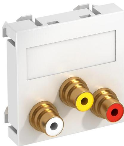
Supoorte de multimédia com três tomadas de ligação RCA para áudio-vídeo, saída de cabo plana, com campo de inscrição, três acoplamentos RCA na versão tomada-tomada, codificação a cores em amarelo/vermelho/branco. Espelho com fixação por encaixe, adequado para a montagem horizontal e vertical em todo o sistema.
