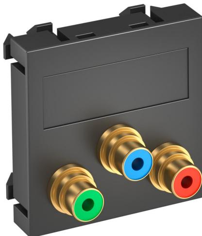
Suporte de multimédia com três tomadas de ligação RCA para Component Video, saída de cabo plano, com campo de inscrição, três acoplamentos RCA na versão tomada-tomada, codificação a cores em vermelho/verde/azul. Espelho com fixação por encaixe, adequado para a montagem horizontal e vertical em todo o sistema.
